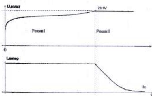
Зависимость величины зарядного тока ( $I$ ) от напряжения на аккумуляторе ( $U$ ) в разных режимах работы устройства показана на рисунке.
